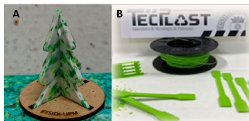
Figura 2: A) árboles de Navidad y B) filamento para impresión 3D; obtenidos con placas de PLA.
